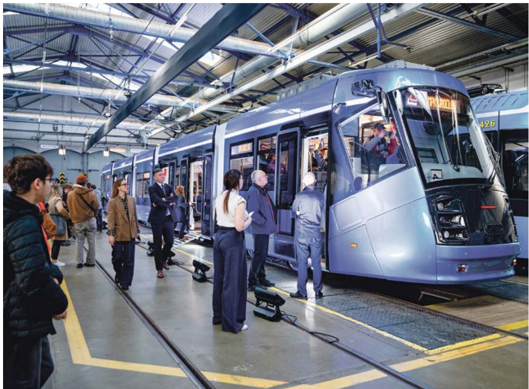
Skoda 19 T została przejrzana i niemal wszystkie jej części wymienione lub zregenerowane
