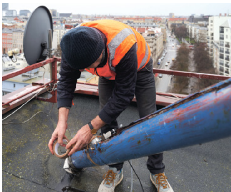
Naukowcy z PWr montują na linach Trzonolinowca aparaturę badawczą
