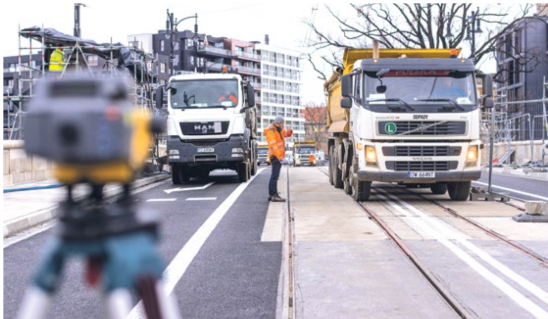
Wtorek, 10.01 – testy obciążeniowe: prześła wytrzymały bez problemu ciężar 80 ton czterech ciężarówek
