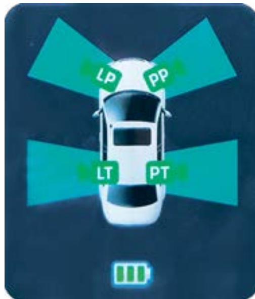
Kamery w pojeździe w trakcie procesu skanowania tablic rejestracyjnych w SPP
