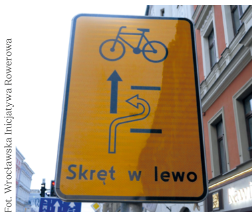
Fot. 14. Do bezpiecznego skręcania w lewo „na dwa razy” na dużych, niebezpiecznych skrzyżowaniach można wykorzystać z powodzeniem służbę rowerową na ulicy prostopadłej. W niektórych miejscach podpowiadają takie zachowanie specjalne tablice.
