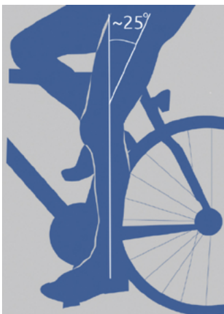
Fot. 28. Jazda na zbyt niskim siodle jest bardzo męcząca, utrudnia utrzymanie równowagi na rowerze, a na dłuższą metę może być szkodliwa dla naszych kolan. Niestety jest to bardzo zły nawyk, który koniecznie trzeba wyeliminować! Noga, spoczywając na pedale w dolnym jego położeniu, powinna być prawie prosta.
