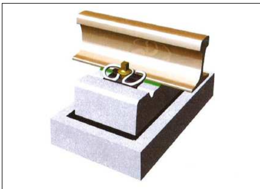
Rysunek 11. System podpór blokowych w otulinie (EBS).
