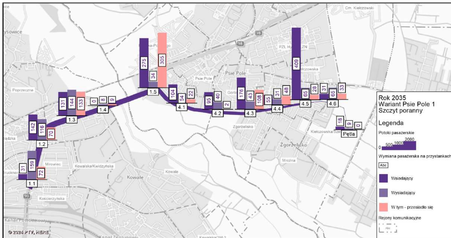
Rysunek 100 Wymiana pasażerska na przystankach tramwajowych projektowanej linii [os/h], szczyt poranny, horyzont 2035, W1
