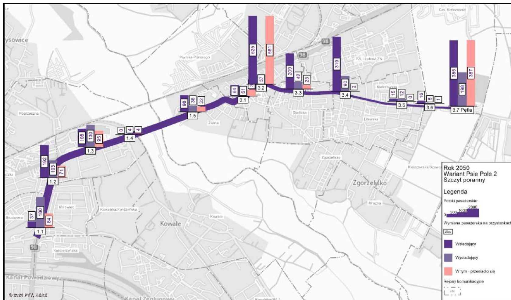
Rysunek 115 Wymiana pasażerska na przystankach tramwajowych projektowanej linii [os/h], szczyt poranny, horyzont 2050, W2
