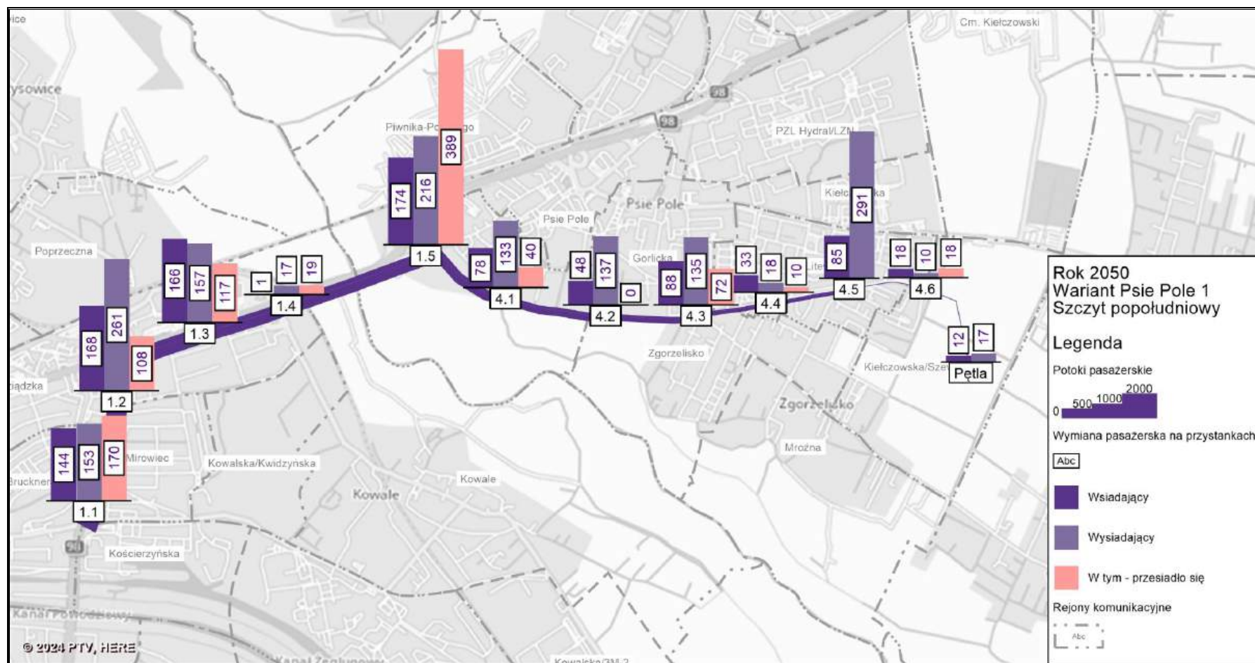
Rysunek 103 Wymiana pasażerska na przystankach tramwajowych projektowanej linii [os/h], szczyt popołudniowy, horyzont 2050, W1
