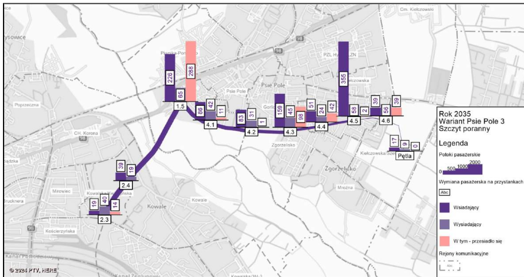
Rysunek 126 Wymiana pasażerska na przystankach tramwajowych projektowanej linii [os/h], szczyt poranny, horyzont 2035, W3
